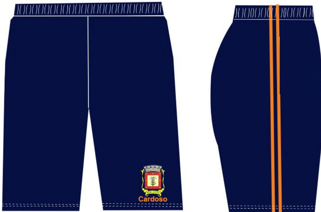
**Produção:** A cintura deverá possuir elástico com largura de 40mm, embutido e rebatido em máquina de ponto corrente de cinco agulhas. As barras das pernas deverão ser rebatidas com largura de 20 mm em máquina pespontadeira com 2 agulhas. A peça deve ser costurada internamente em máquina interloque com bitola de 3 mm, com linha e fio na cor azul marinho.
